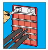
Die Lasche der Schlussdichtung um die Teleskopschraube legen und die Schlussdichtung einschieben. Die Spannschrauben der Schlussdichtung anziehen bis ca. 12mm vom Gewinde hervortreten.
