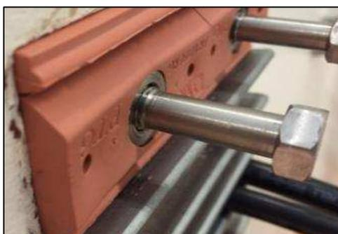
Die Schrauben soweit anziehen bis das Gewinde wie am Bild sichtbar ist.
