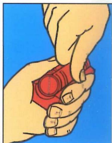
3. Setzen Sie nun Kern (mit Kernadapter) in die Nut des Vario-Packstückes ein. Achten Sie dabei darauf, dass die Teile einrasten und fest miteinander verbunden sind.
