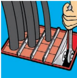
**4** Zunächst die Module an den Außenseiten (A,B,C usw.) platzieren, dann folgen die restlichen. Achtung: Packstück A sollte - wie im Bild dargestellt - um 90°, werden.
