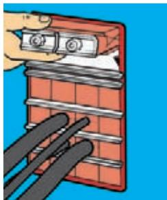
**5** Die PTG zuerst oben am Rahmen positionieren, dann die letzte Lage Module einsetzen.
