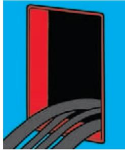
Wählen Sie ein passendes Packstück für das dickste Kabel der jeweiligen Packlage aus.
