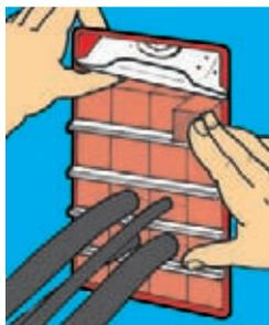
**5-6** Die letzte Lage Module packen, dann Teleskopschraube der Preßplatte anziehen, bis Abstand zwischen Oberseite Preßplatte und Innenseite Rahmen 32 mm beträgt.
