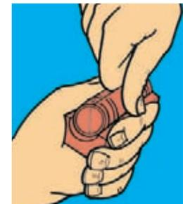
Setzen Sie nun Kern (mit Kernadapter) in die Nut des Variopackstückes ein. Achten Sie dabei darauf, daß die Teile einrasten und fest miteinander verbunden sind.
