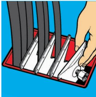
**2** Ziehen Sie die Kabel durch, die dicksten sollen am weitesten entfernt von der Preßplatte platziert werden.
