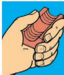
Preparieren Sie ein Vario-Packstück, das zum Durchmesser des (später zu installierenden) Kabels paßt, indem Sie dessen Laschen entfernen (und ggf. aufbewahren).
