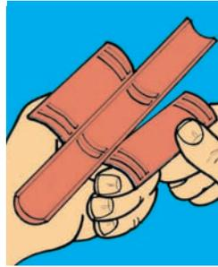
Entfernen Sie diejenige Lasche, welche dem Kabeldurchmesser entspricht.
